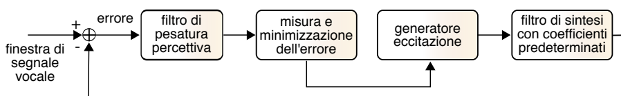
Figura 10.13: Schema di codifica vocale ABS - Analysis by Synthesis
